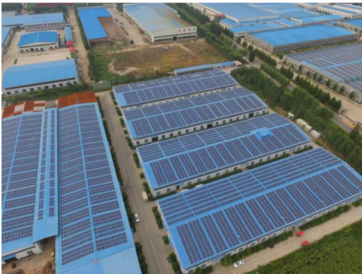
图 5.1-1 彩钢瓦屋顶分布式光伏安装示意图
